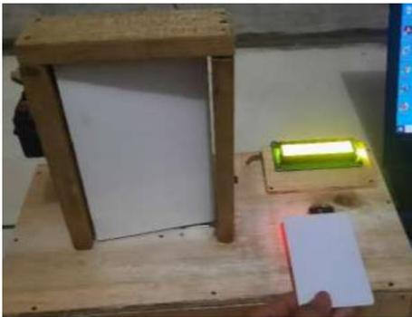
Gambar 13. Menempelkan RFID Tag ke RFID Reader
