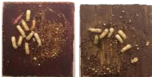
Gambar 5. Butiran-butiran Bulat dan Kecil Berwarna Coklat sebagai Ciri Serangan Rayap Kayu Kering Mengonsumsi Selulosa pada Kayu Kelapa Terimpregnasi PF
